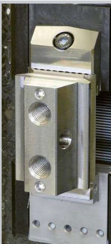
Lineare Direktprägespannung Linear direct stamping module
